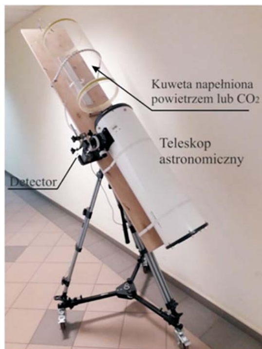
Zestaw do pomiaru transmisji promieniowania podczerwonego z Księżyca w dwutlenku węgla (J.Kubicki i inni)
